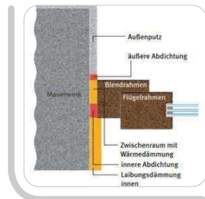
- Einbau mit Laibungsdämmung
